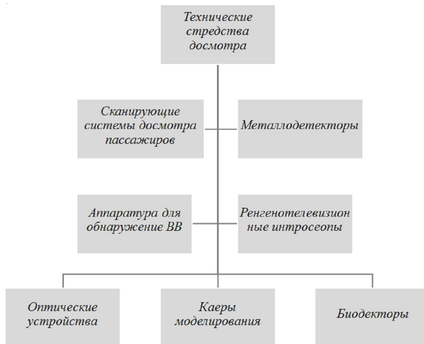
Рис. 2. Виды специальных технических устройств, применяемых в аэропортах
