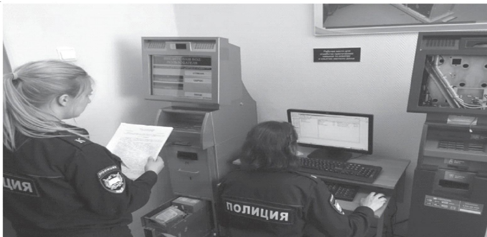
Рис. 1. Осмотр операционной системы скомпрометированного устройства самообслуживания. Исследование журнала событий с целью поиска событий, влияющих на настройки политики безопасности системы
